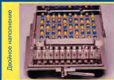
10. Используйте лопатку для равномерного наполнения капсул. Переместите остатки порошка на накопитель
